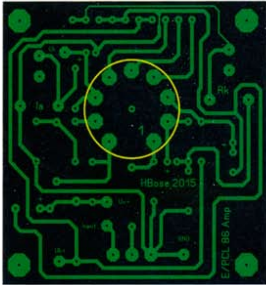
Lötseite der Verstärkerplatine im Format 70 mm x 72 mm
