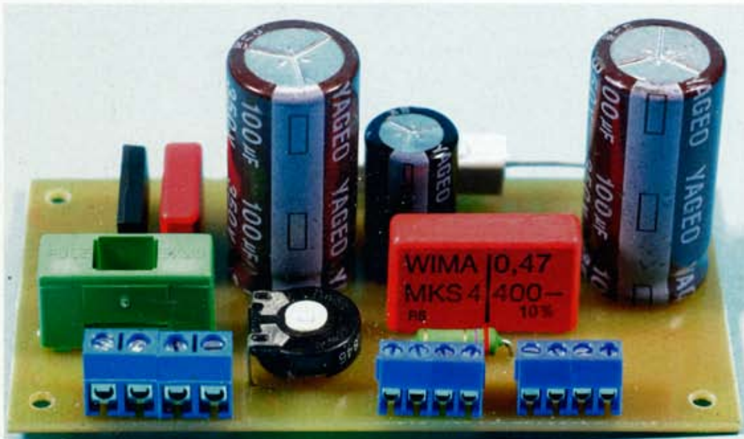
Die fertig bestückte Platine des Netzteiles für Röhrensaltungen
