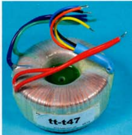
Dieser Ringkerntrafo kommt im Netzgerät für Röhrensaltungen zum Einsatz.
