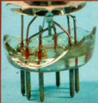
Röhrensockel einer EL83 mit Glasboden und Heizungsanschlüssen
