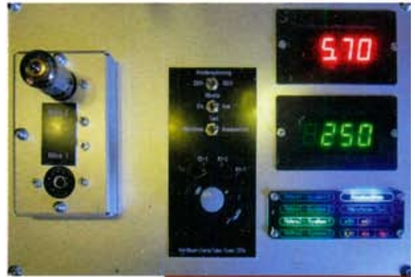
Ein Selbstbau-Vorröhren-Tester für Gitarrenverstärker
